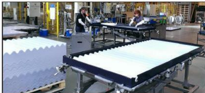
Les capteurs absorbent l'énergie solaire, la transmettent à un fluide, le glycol, qui serpente dans le méandre en cuivre jusqu'à l'échangeur du ballon d'eau chaude. Les futurs capteurs intelligents de Viessmann éviteront tout problème de surchauffe du glycol et donc de détérioration des installations. Les premières productions sont programmées pour cet automne. Photo XL
